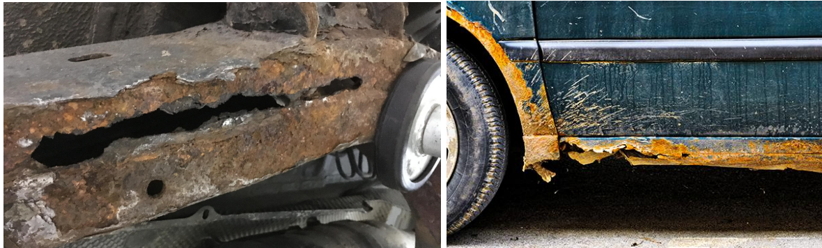
Corrosion perforante sur châssis et carrosserie.
