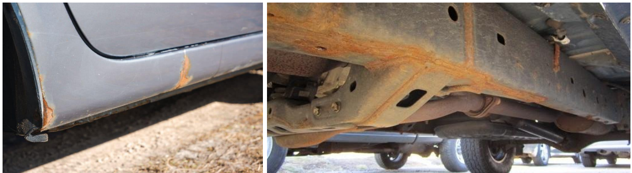
Rouille de surface sur carrosserie et châssis.
