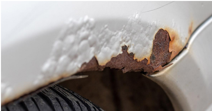
Corrosion perforante sur carrosserie.
